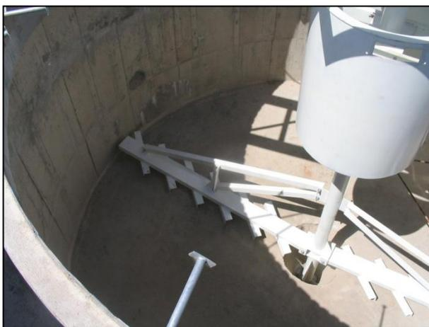
Sistema de Limpieza de Sedimentador Mecanizado
